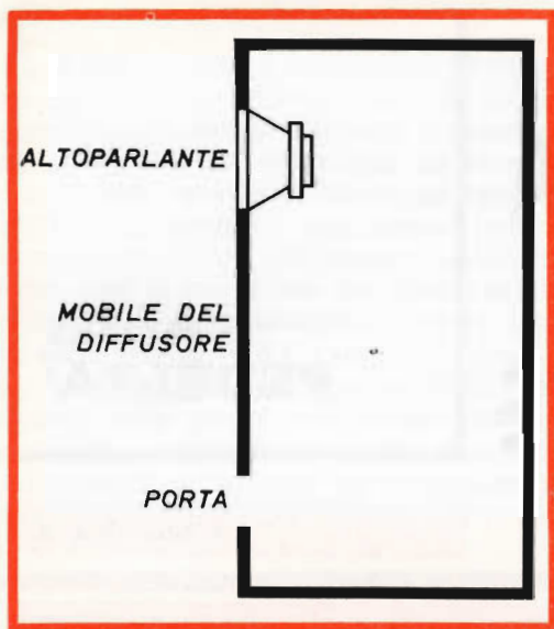
Fig. 1 - Vista in sezione di un bass reflex.
